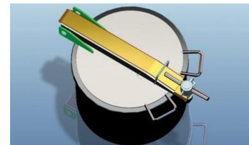
Кришка люка з запірним механізмом котла залізничної цистерни
