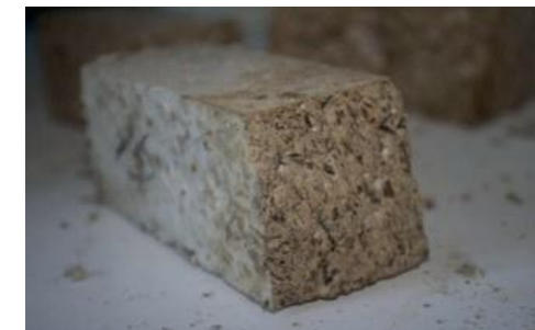
Арболіт з високим вмістом відходів опалого листя
