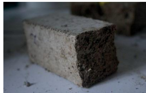
Гіпсовий будівельний матеріал, що містить відходи у вигляді опалого листя до 20 % ваги гіпсової суміші
