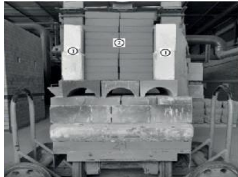
Вагонетка з садкою до реконструкції 1- муфель, 2 – вироби
