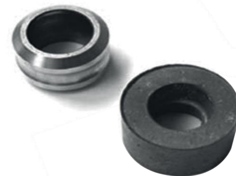
Заготовка (праворуч) та готовий ролик (ліворуч) дротопрокатного стану
